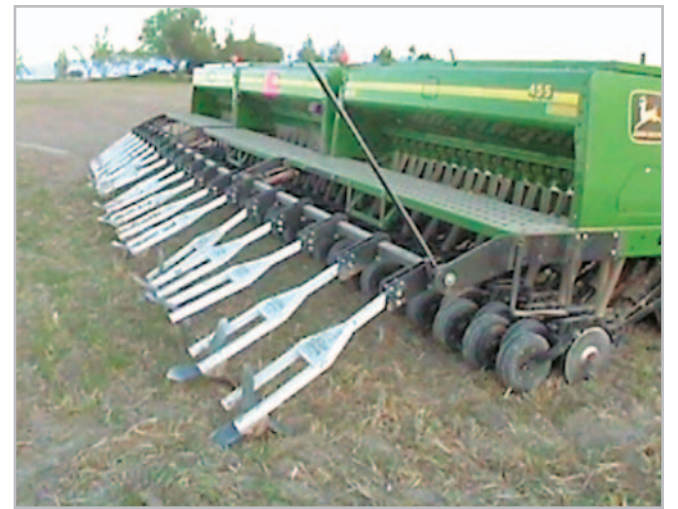
Obr. 3 – Podobně i secí stroje pro širokořádkové plodiny lze vybavit důlkovacími tělesy
