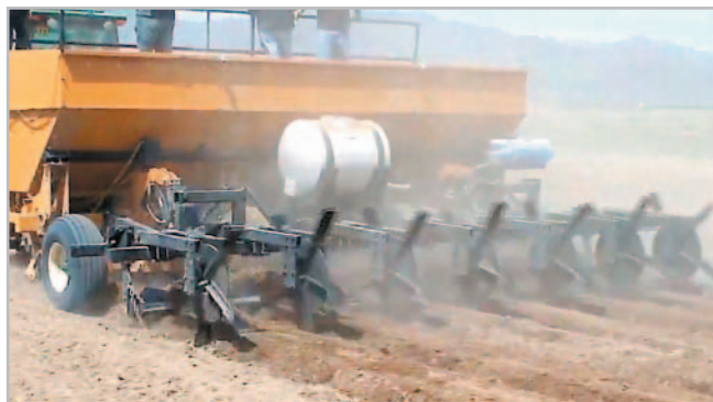
Obr. 2 – Hrázkovací těleso lze umístit přímo na sázeč a vytvořit tak asi 28 tisíc minirezervoárů na hektar, které zachytí přibližně 56 m³ srážkové vody
