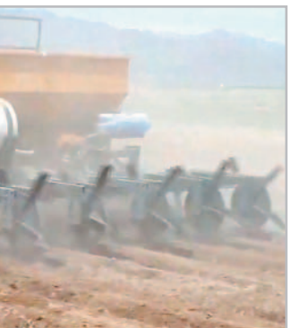
Obr. 2 – Hrázkovací těleso lze umístit přímo na sázeč a vytvořit tak asi 28 tisíc minirezervoárů na hektar, které zachytí přibližně 56 m³ srážkové vody
