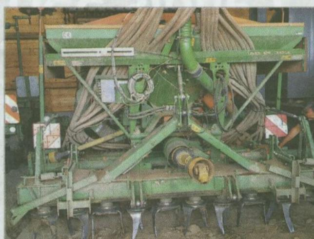
Secí stroj Amazone AD-PL 302 – kombinací k sečímu stroji je rotační vřívý kypřič s vertikálními noži, které připraví sefové lůžko
