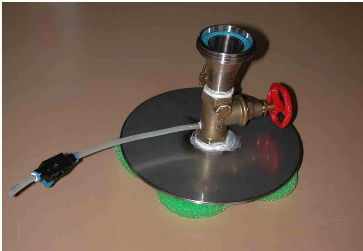
Obr. 5. Vakuovací koncovka s ventilem (nadhled) – upevňuje se na každý ochranný vak.
