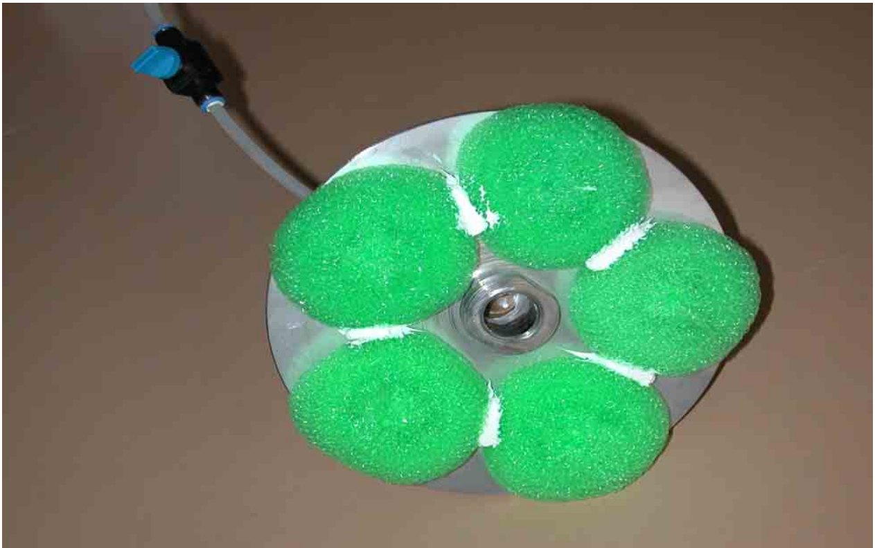
Obr. 6. Vakuovací koncovka s ventilem (spodní pohled)
