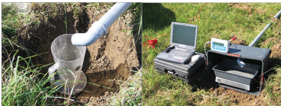
Obr. 1 Původní ruční odečet objemu povrchového odtoku vody pomocí odměrných nádob (vlevo – 1a) a zařízení pro jeho měření a vyhodnocení – digitální váhy Radwag WLC6 a PC (vpravo – 1b) FOTO: Kovaříček
