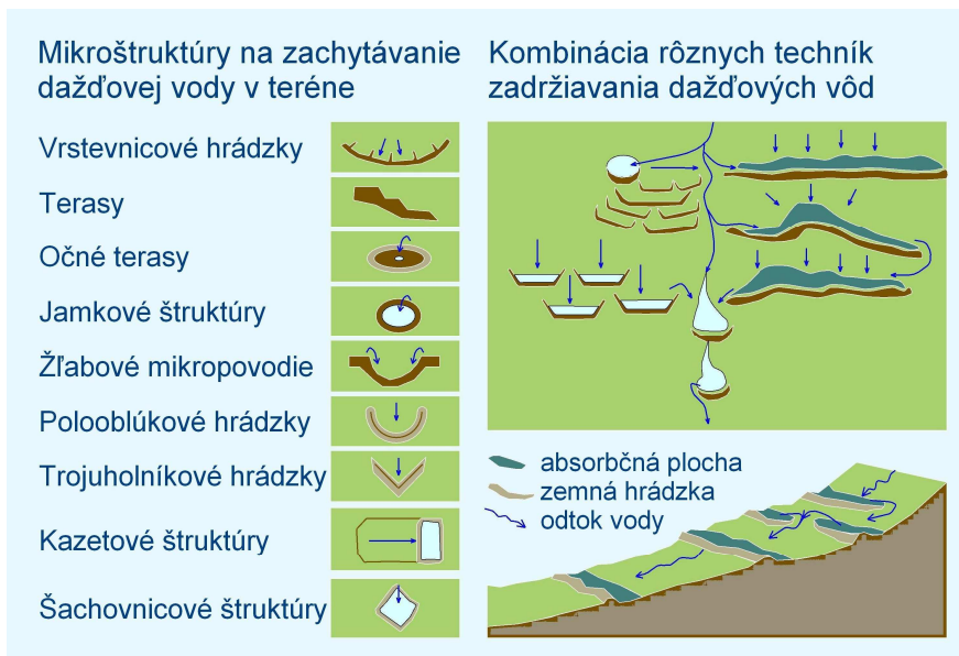
Obr. 33 Schémy technických opatrení na protieróziu ochranu územia a zadržiavanie dažďovej vody v území
