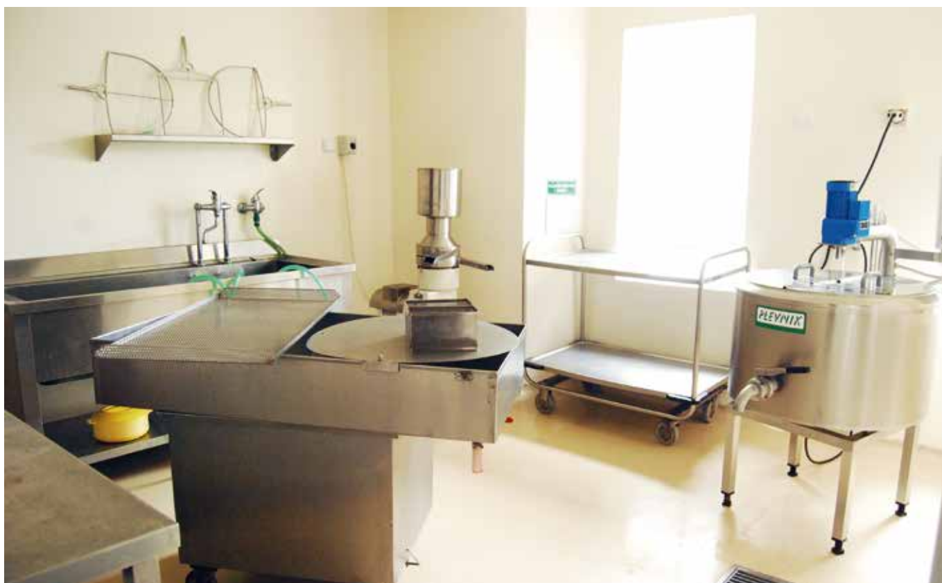
Sýrárna (kotlový pastér, odstředivka, „harfy“, nerezová podložka a formy na formování sýrů)
