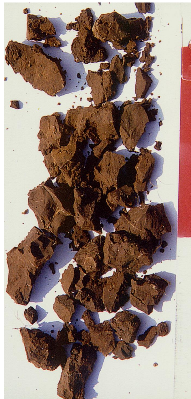
Profil se zřetelnou pedokompakcí a nepříznivou strukturou
