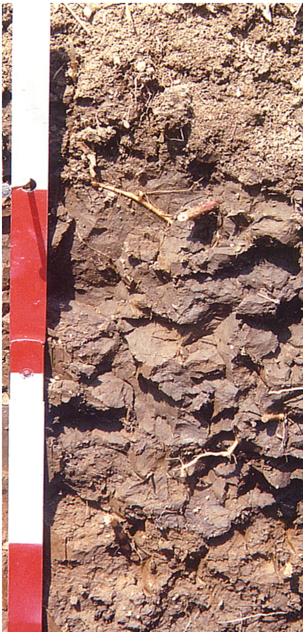
Profil se zřetelnou pedokompakcí a nepříznivou strukturou
