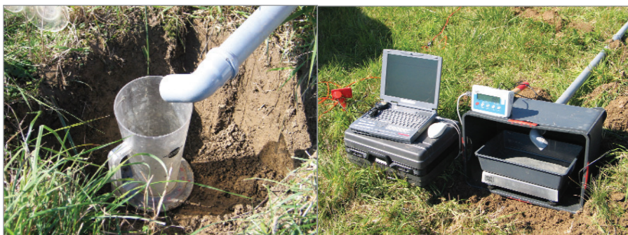
Obr. 1 Původní ruční odečet objemu povrchového odtoku vody pomocí odměrných nádob (vlevo – 1a) a zařízení pro jeho měření a vyhodnocení – digitální váhy Radwag WLC6 a PC (vpravo – 1b) FOTO: Kovaříček
