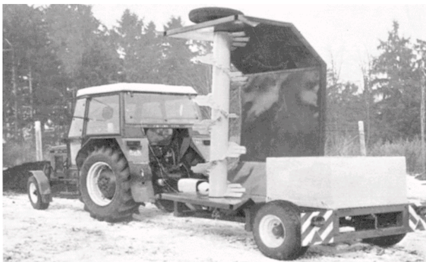
Obrázek č. 9: Překopávač kompostů PK 250 firmy Nuclea pro malé kompostárny
