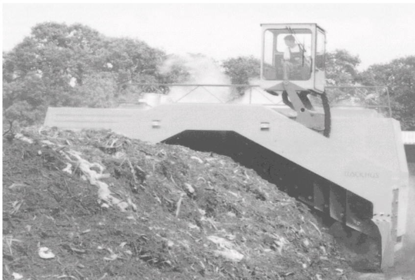
Obrázek č. 10: Čelní překopávač firmy Backhus, vhodný pro velké kompostárny
